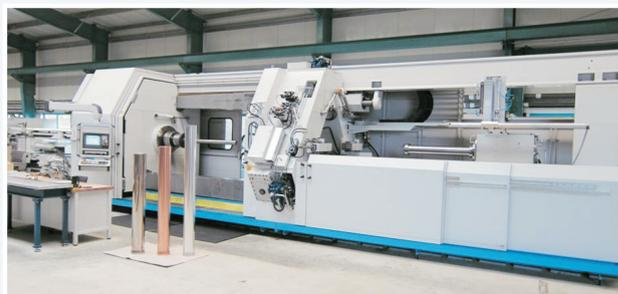
Weiterhin wurde in eine neue kraftstarke Drückmaschine zur Herstellung von kegeligen Blechformteilen investiert. Hiermit lassen sich auch dickwandige Kegel mit Wandstärken von 20 mm bei Durchmessern von bis zu 2000 mm umformen. Somit können auch dickwandige Vorformen, die weiterführend mechanisch bearbeitet werden, umgeformt werden, wobei der Materialeinsatz reduziert wird.
